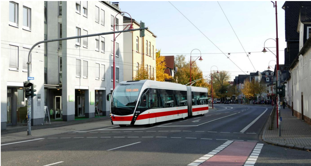
Abbildung 1.5: Oberleitung (zweispurig ausgebaut) und batteriebetriebener Oberleitungsbus (Fahrtrichtung Wilhelmsplatz) in der Schwanallee (Quelle: Stadtwerke Marburg GmbH)
